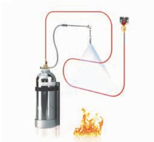
Rotarex FireDETEC®-Systeme verwenden einen patentierten kontinuierlichen Linearsensorschlauch, der zuverlässig detektiert und pneumatisch die Freisetzung des Löschmittels auslöst. Sie sind flexibler, platzsparender und kostengünstiger als alternative mechanische oder elektrische Systeme.
