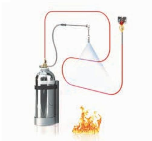
I sistemi FireDETEC® di Rotarex utilizzano un tubo di rilevazione lineare continuo brevettato che rileva il principio di incendio e attiva in modo affidabile la liberazione di agente estinguente mediante una tecnologia pneumatica. Sono più flessibili, meno ingombranti e meno costosi dei sistemi alternativi elettrici o meccanici.
