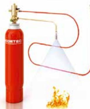
I sistemi FireDETEC® di Rotarex utilizzano un tubo di rilevazione lineare continuo brevettato che rileva il principio di incendio e attiva in modo affidabile la liberazione di agente estinguente mediante una tecnologia pneumatica. Sono più flessibili, meno ingombranti e meno costosi dei sistemi alternativi elettrici o meccanici.
