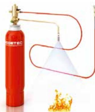
I sistemi FireDETEC® di Rotarex utilizzano un tubo di rilevazione lineare continuo brevettato che rileva il principio di incendio e attiva in modo affidabile la liberazione di agente estinguente mediante una tecnologia pneumatica. Sono più flessibili, meno ingombranti e meno costosi dei sistemi alternativi elettrici o meccanici.
