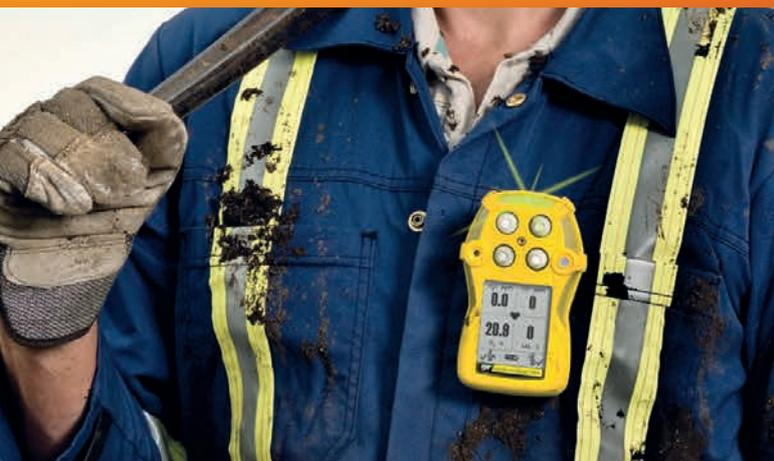
**Le détecteur de gaz portable est un appareil mesurant les concentrations de différents gaz présents dans l'atmosphère.**
