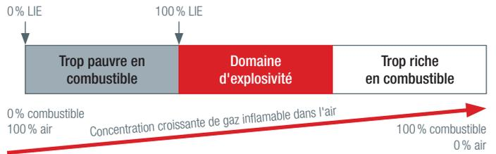
Pour chaque gaz explosible, la LIE et la LSE se déterminent en fonction de sa concentration en volume d'air.
