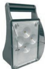
Cette gamme permet de répondre aux exigences de la réglementation dans certains types de locaux (éclairage sécuritaire pour locaux techniques...). Branchées sur une prise de courant, ces lampes s'allument automatiquement en cas de coupure secteur. S'agissant d'un bloc d'ambiance portatif, sa puissance doit être à minima cohérente avec la superficie du local (5 lumens au m<sup>2</sup>).
